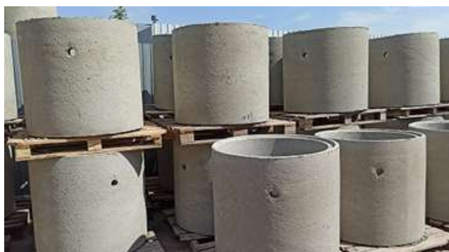
Кольца колодезные бетонные: КС10.9 / КС8.9 с пазами
