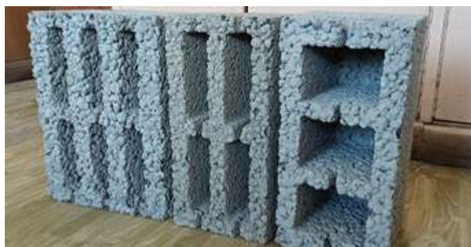
Керамзитобетонные блоки (Керамзитоблок): 390-188-190 мм / 390-188-290мм
