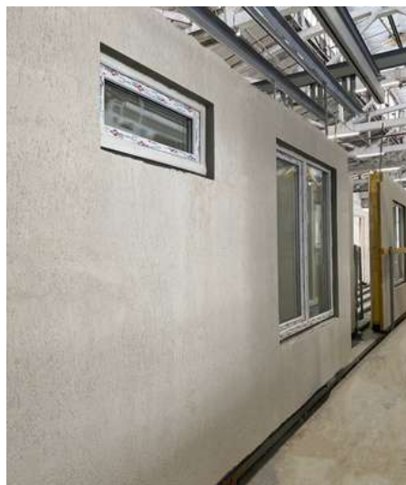
Наружная стеновая панель с фасадом из декоративной штукатурки
