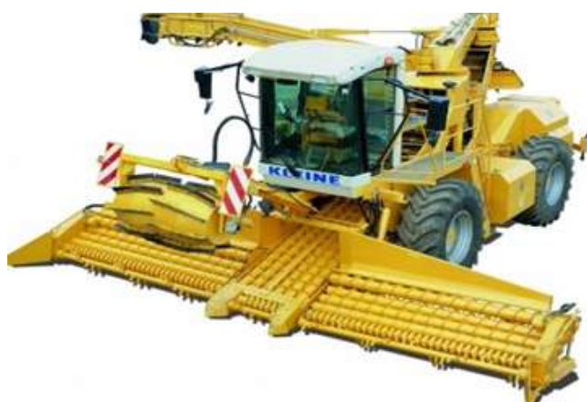
Самоходный свеклопогрузочно-очистительный комбайн RL 200
