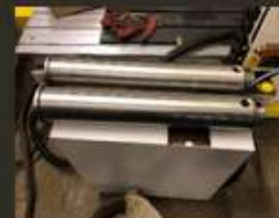
Палец ковшевого узла Hitachi
