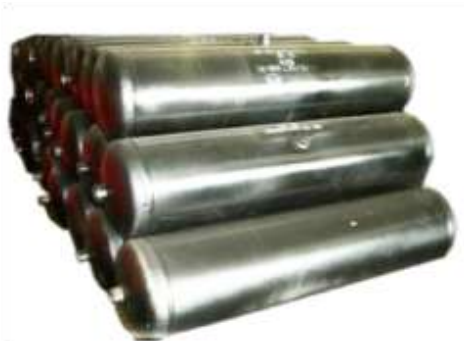
Резервуары воздушные для тормозов вагонов
