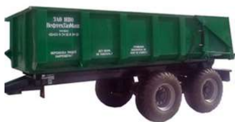
Полуприцеп тракторный самосвальный НГМ 003 грузоподъемностью 18 т.
