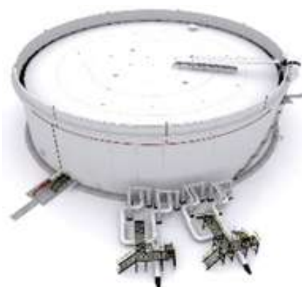
Резервуар вертикальный стальной с плавающей крышей (РВСПК)
