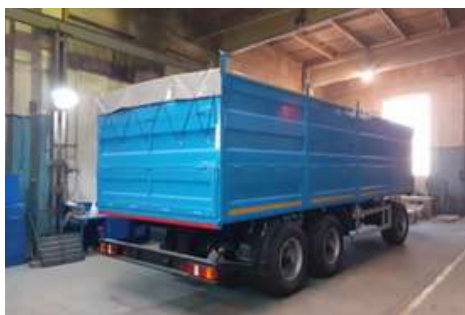
Прицеп бортовой трехосный - зерновоз. Объем перевозимого груза-33 м2.
