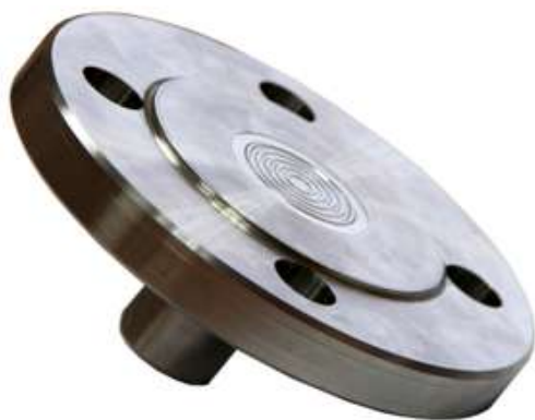
Разделитель мембранный фланцевый открытый (по ГОСТ, DIN, ANSI). Защита измерительных устройств от агрессивных рабочих сред
